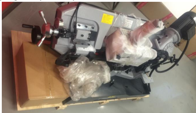
Рис. 2 Типовая транспортная упаковка станка.
