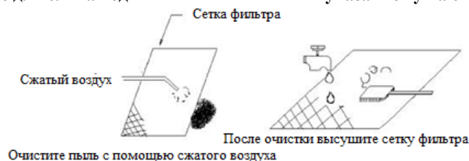
Рис. 57 Схема чистки воздушных фильтров
