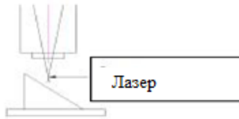
Рис. 43 Регулировка фокуса лазера 1
