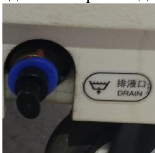
Рис. 55 Поверните сливной выключатель по часовой стрелке для слива воды
