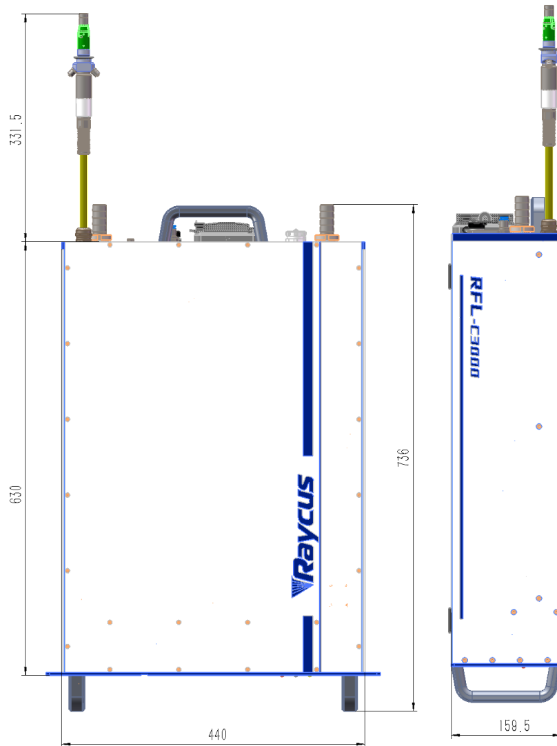
Рис. 2 (с) Вид сверху и сбоку RFL-C3000S (единица измерения: мм)
