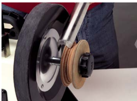
Профилированный съемный кожаный круг (арт.: 708028)
