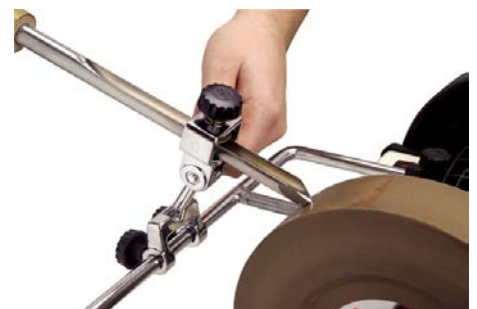
Приспособление для заточки овальных и полукруглых стамесок (арт.: 708020)
