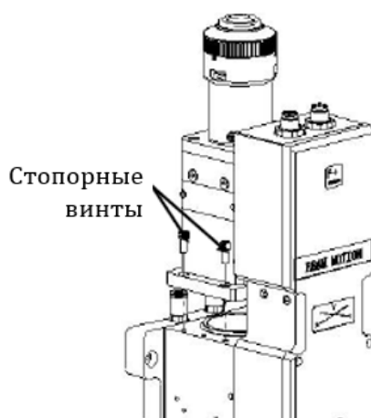
Рисунок 6.3 – Расположение стопорных винтов коллиматора
