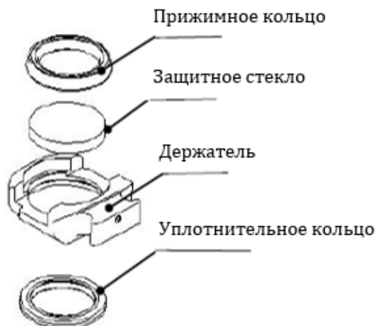
Рисунок 6.2 – Структура картриджного держателя защитного стекла
