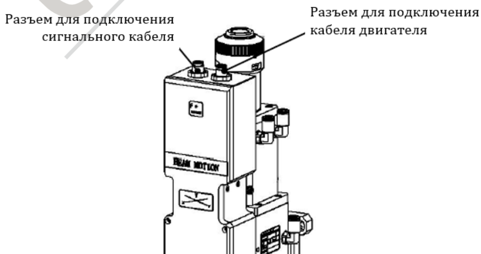
Рисунок 3.3 – Подключение кабелей к режущей головке
