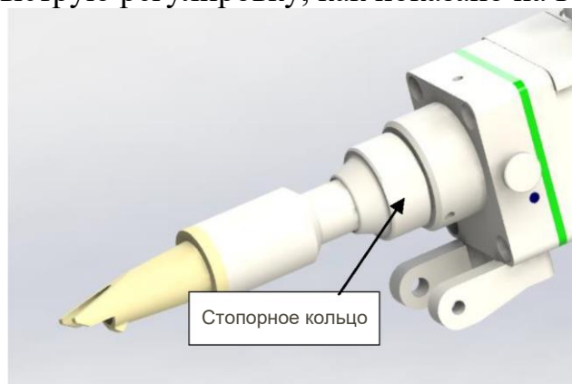
Рис. 9 Ручка настройки расположения фокуса в аппарате НW970
