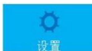
Рис. 49 Значок редактирования пользовательских настроек, параметров станка, параметров оси, резервного копирования/восстановления и отображение информации о версии программного обеспечения
