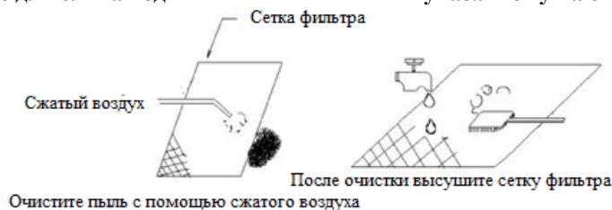
Рис. 56 Схема чистки воздушных фильтров
