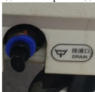
Рис. 54 Поверните сливной выключатель по часовой стрелке для слива воды
