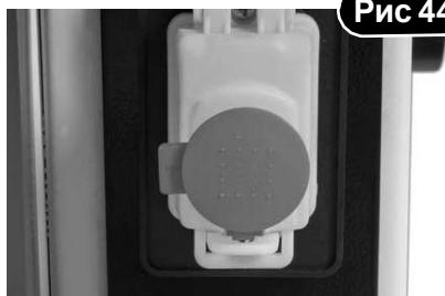
Крышка кнопки аварийного останова, для останова станка стукните по крышке.
