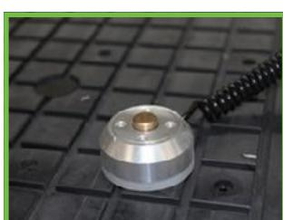
Датчик измерения и калибровки длины инструмента
